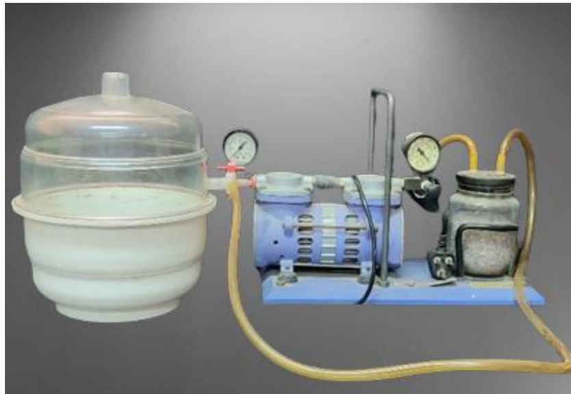
Şekil 4. Laboratuvar ölçekli vakumlu emdirme sistemi (Vinod ve ark., 2024).
