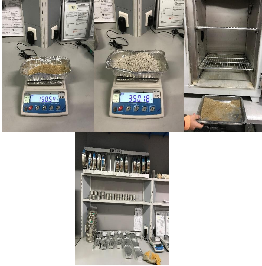
Şekil 2. Elek Analizi deneyinin yapım aşaması
