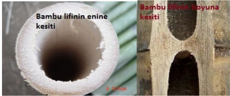
Şekil 1. Bambu lifinin boyuna ve enine kesiti [3].
