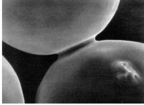
Şekil 4. Sinterleme Prosesinde Taneler Arası Boyun Verme İşlemi (Şenel, 2018).
