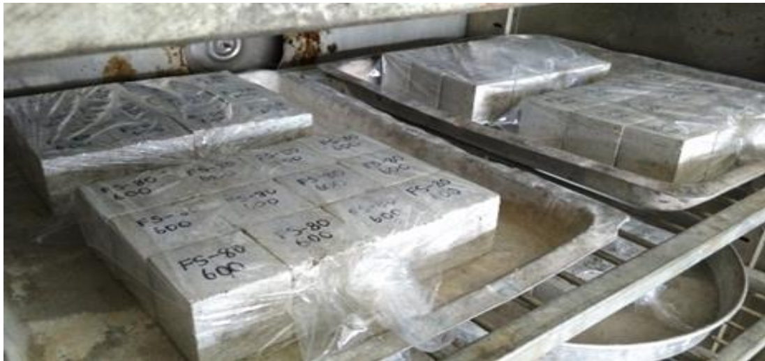
Şekil 3. 90^\circ\text{C} 'lik ısı kürüne yerleştirilmiş poşetli numuneler
