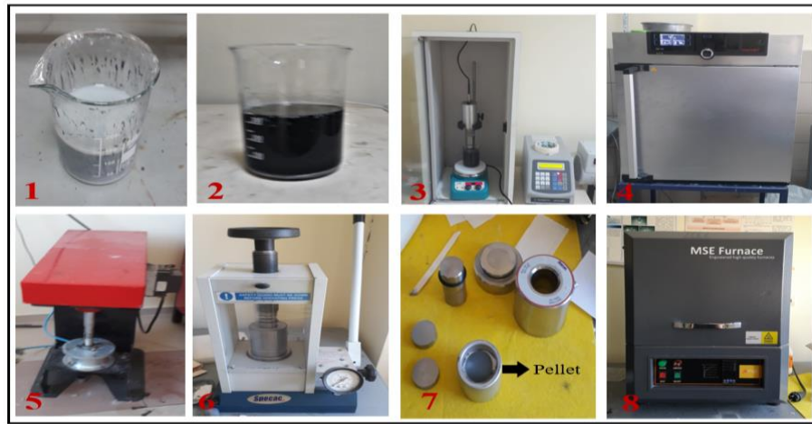
Şekil 2. Kompozit numunelerin üretim aşamaları
